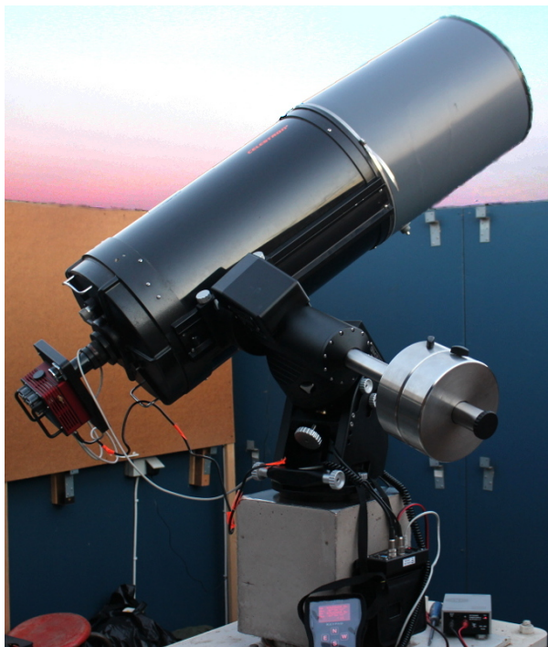
Figur 4: Tycho Brahe-observatoriets fjärrstyrda teleskop. (Tycho Brahe-observatoriet, 2015)
